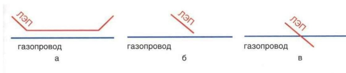
Рис. 1. Параллельное (а) и косое сближение (б), пересечение (в) ЛЭП с трубопроводом
