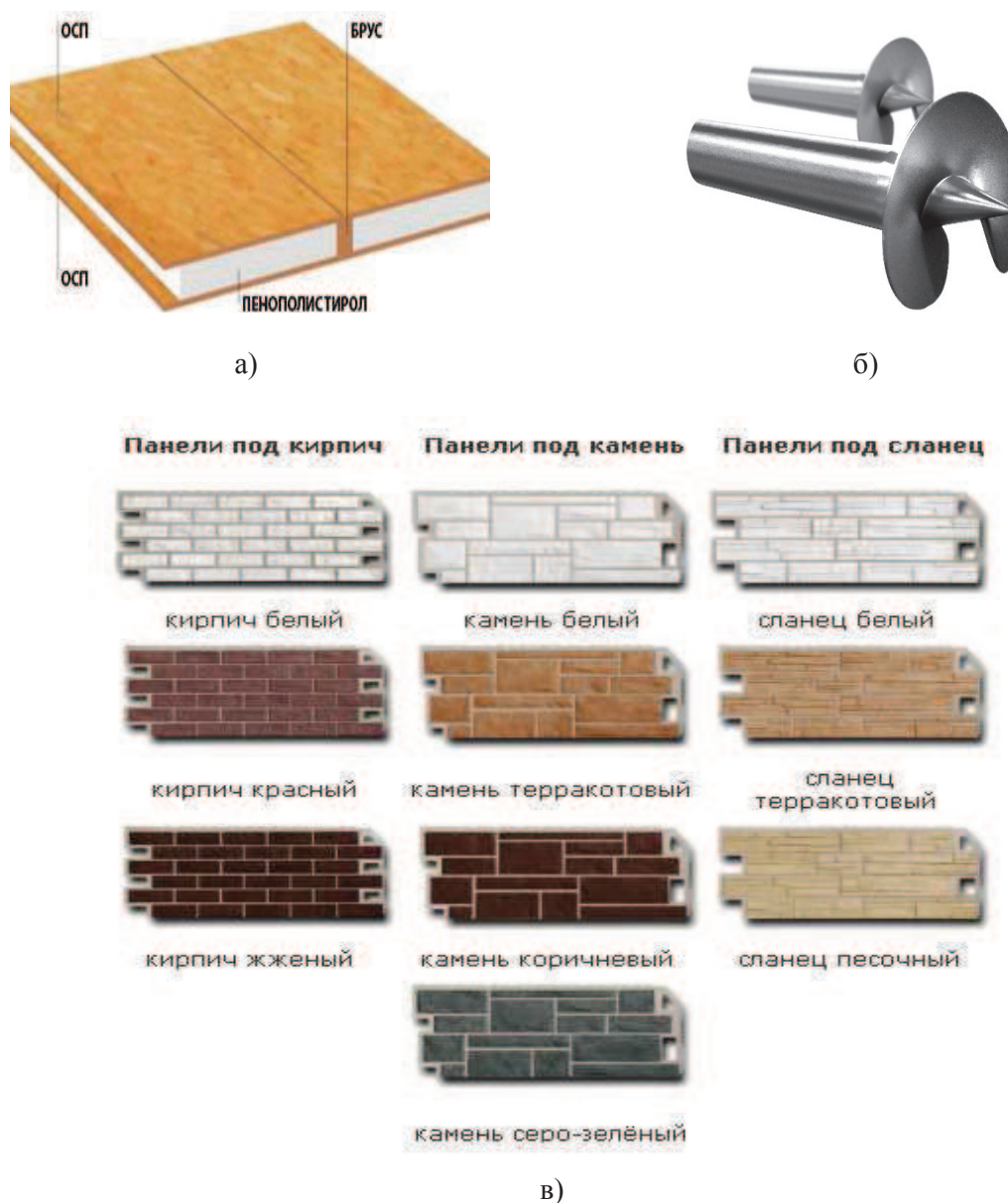
Рис. 1. Конструктивные элементы: а) структурная изолированная панель; б) винтовая свая; в) панели, используемые для отделки фасадов
