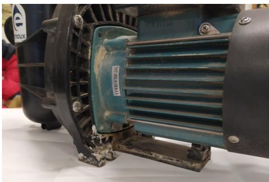
Рис. 1. Общий вид насоса со следами протечки
