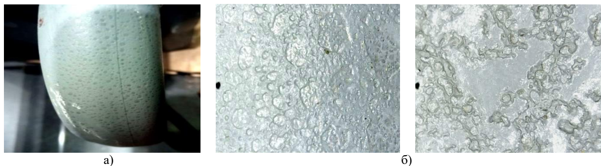
Рис. 5. Дефекты ЛКП отопительного прибора: а – в виде нарушения сплошности окрашивания; б – связанные с нарушением технологического процесса нанесения лакокрасочного покрытия
