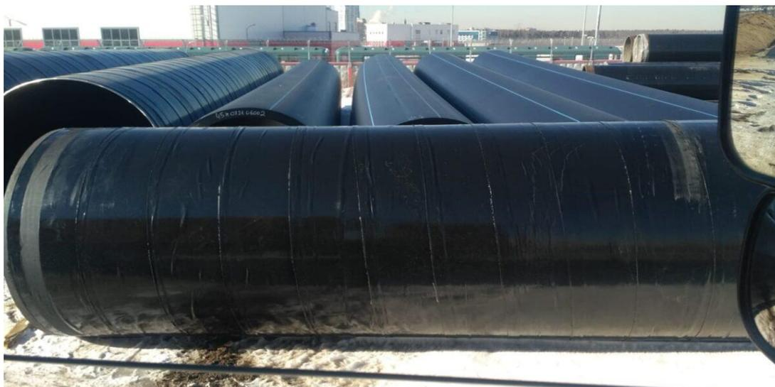
Рис. 1. ВУС- изоляция трубы [1]
