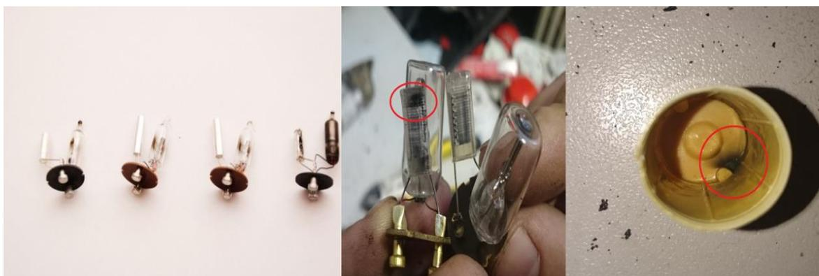
Рис. 3. Фото стартеров со следами термического воздействия
