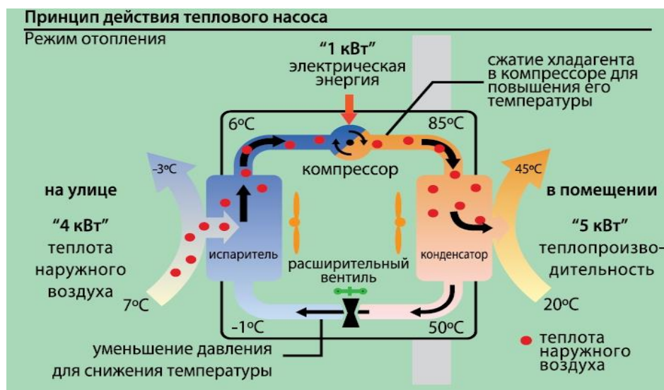
Рис. 1. Схема работы теплового насоса
