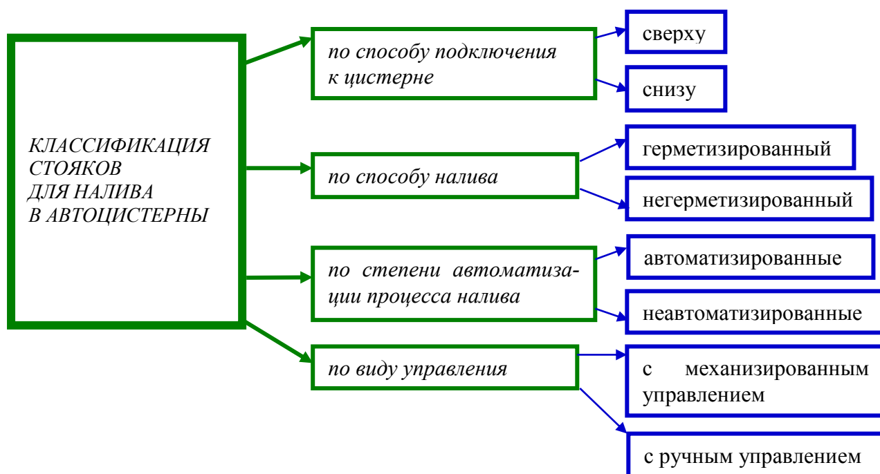
Рис. 2. Классификация стояков для налива в автоцистерны
