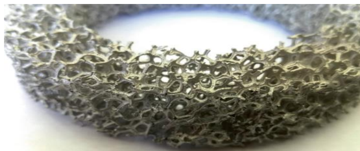
Рис. 3. Внутренний шумоглушитель для регулятора РДП из пеноматериала
