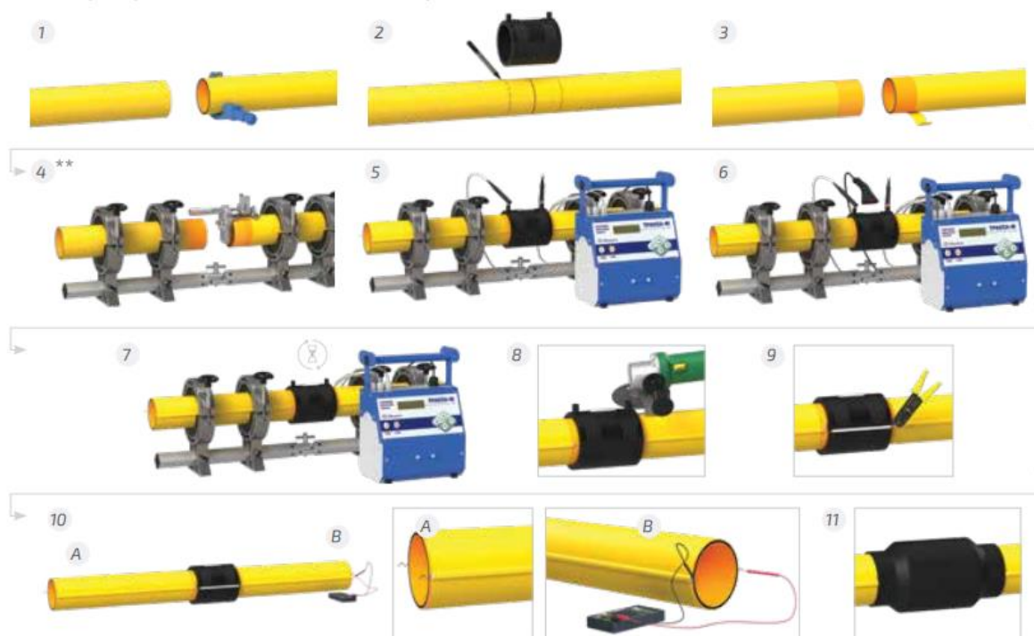
Рис. 4. Сварка полиэтиленового газопровода с электросварными фитингами из труб серии «Детект» [3]
