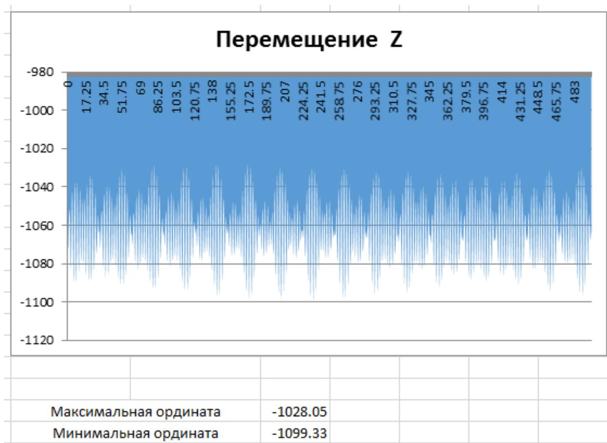
**Рис. 7.** Амплитуда колебаний пролетного строения с демпферами
