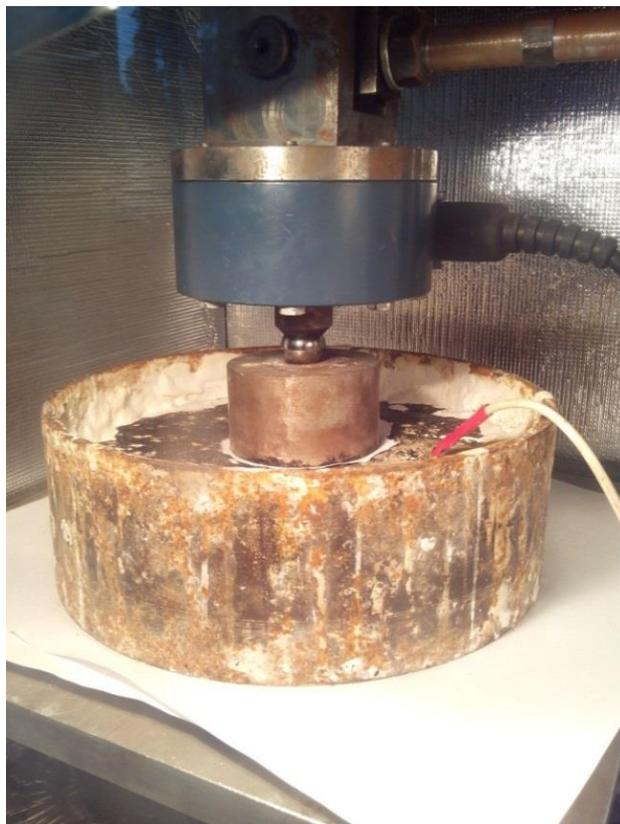
**Рис. 4.** Испытание образца ЩМА в ПДИ
