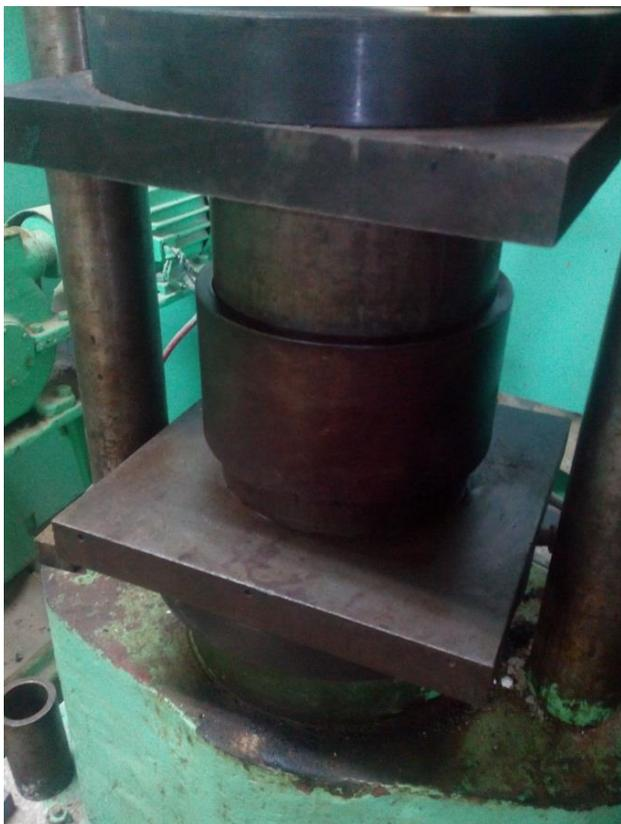
**Рис. 3.** Формовка образцов ЩМА в нестандартной форме
