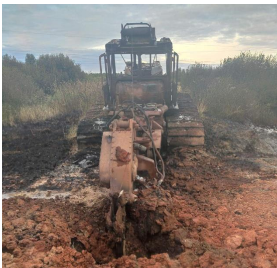
Рис. 2. Механическое воздействие на газопровод клыком-рыхлителем экскаватора (8,5 км газопровода отвода к г. Фурманов и к г. Приволжск, 13.08.2020) [3]
