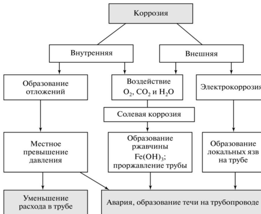
Рис. 1. Механизм развития процессов коррозии на металлических трубопроводах [2]
