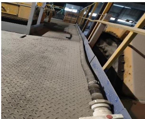
Рис. 6. Шланг для подачи обратного шлама
