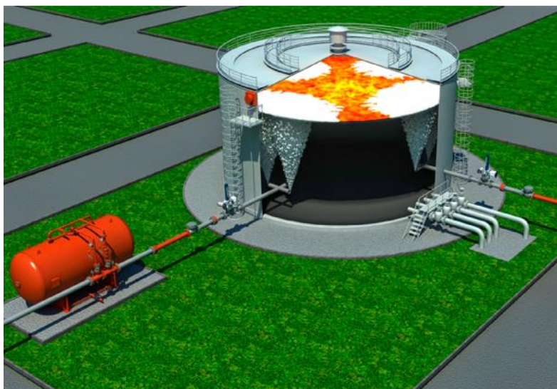
Рис. 2. Подслойный способ тушения РВС [2]
