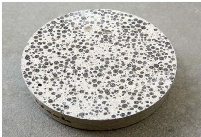
Рис. 3. Экспериментальный образец гибкого бетона [4]
