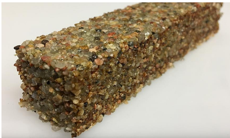
Рис. 2. Опытный образец самовосстанавливающегося инженерного цементующего композита, имеющего в составе нитрифицирующие бактерии [2]
