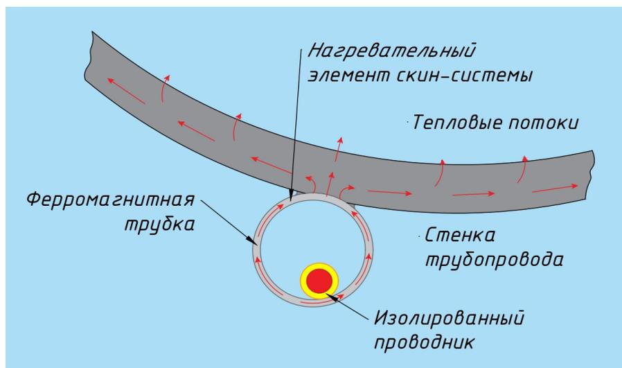
**Рис. 1.** Принцип действия скин-системы
