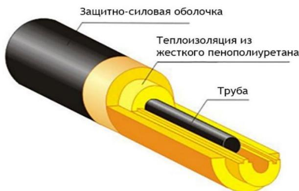
Рис.3. Теплоизоляция из пенополиуретана [3]
