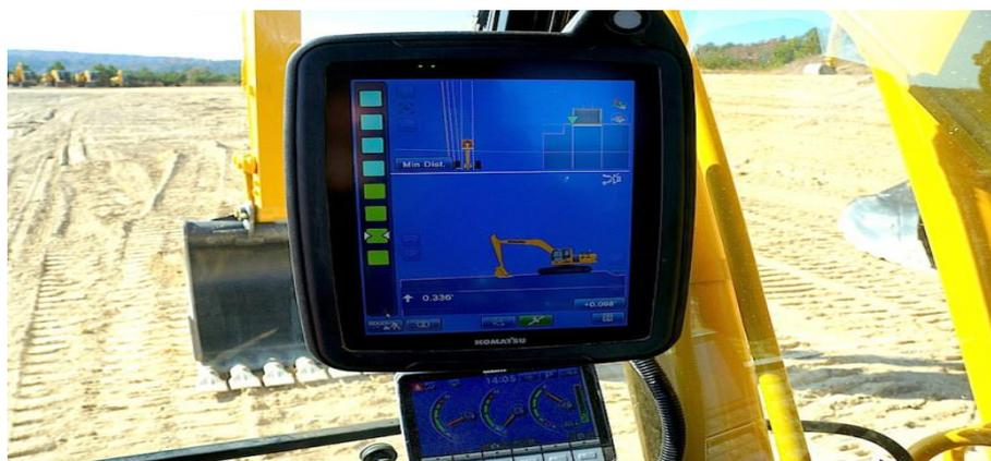
**Рис. 4.** Одноковшовый экскаватор с обратной лопатой и системой интеллектуального управления за работой [3]
