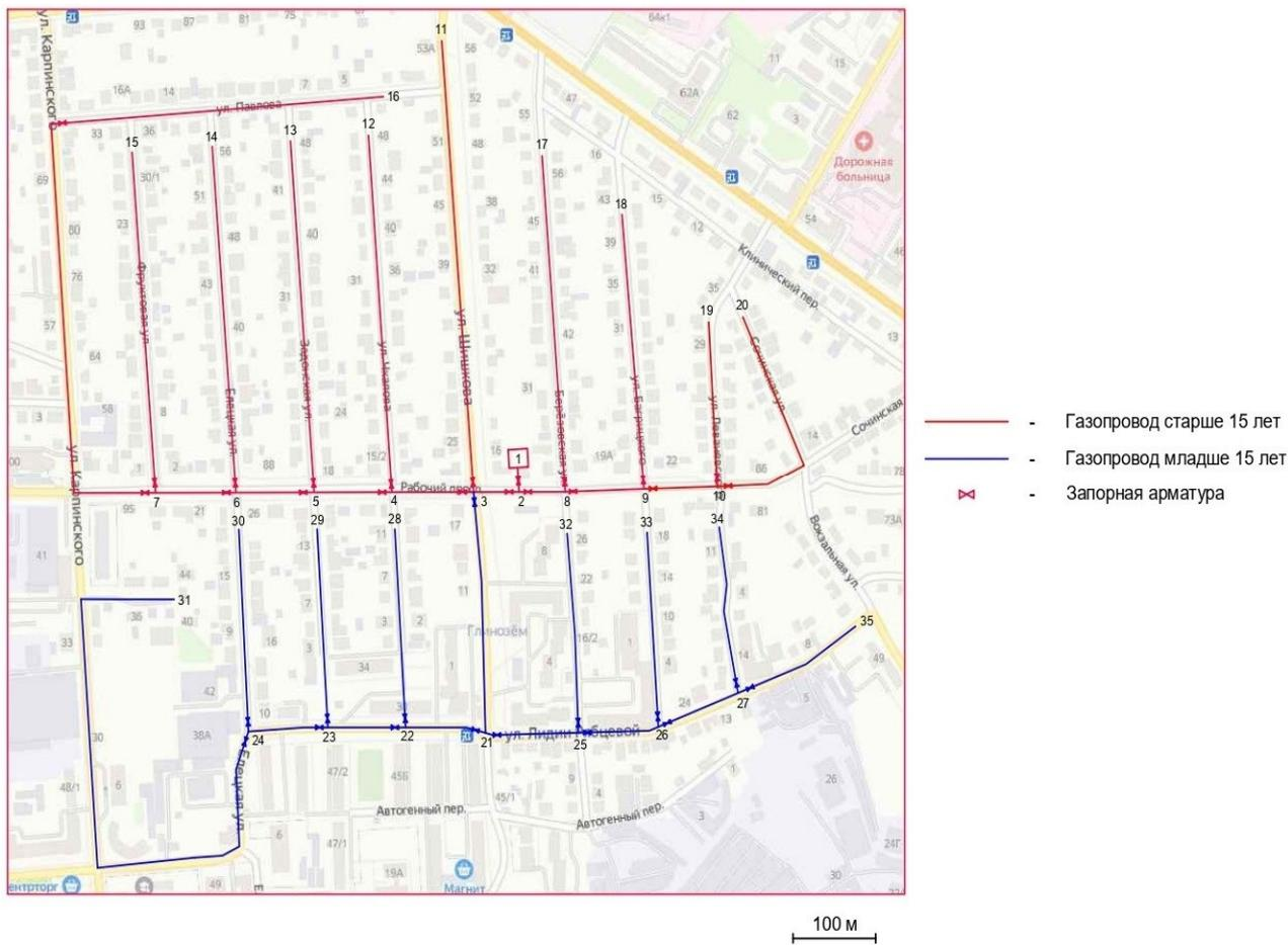
Рис. 2. Схема газовой распределительной сети
