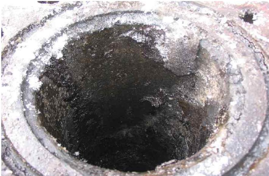
Рис. 3. Отложения механических примесей на металлическом оборудовании [5]
