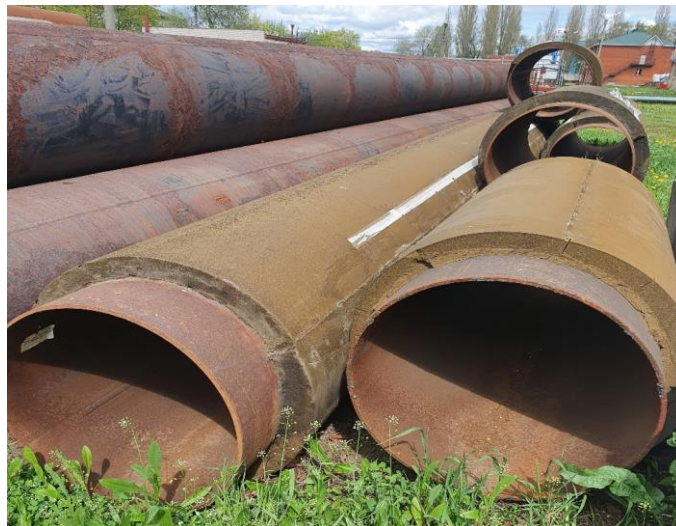
Рис. 4. Трубопроводы с ППМ изоляцией [9]
