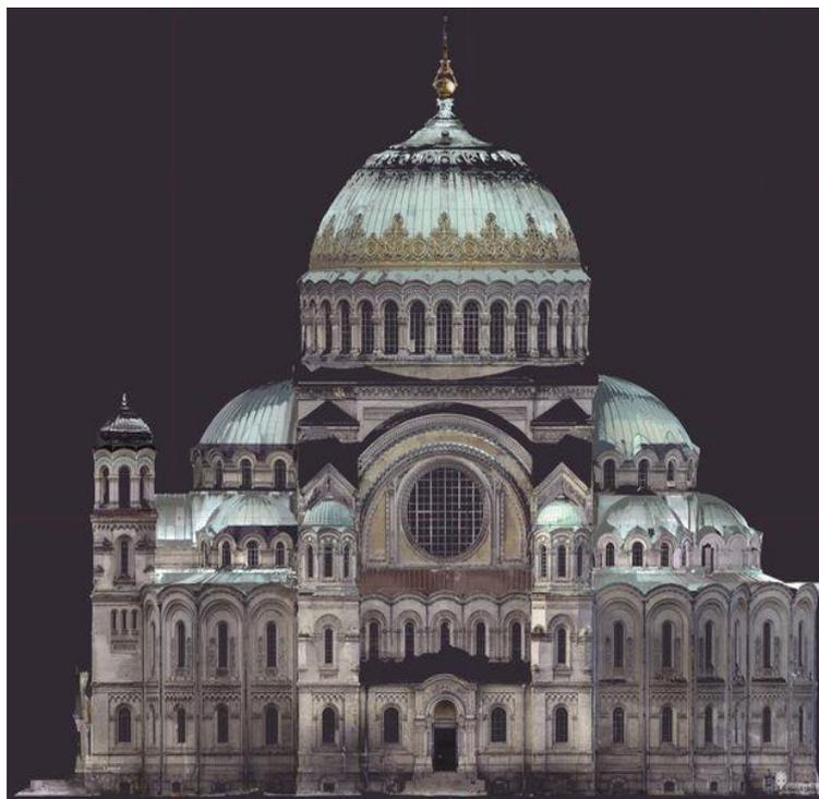
**Рис. 1.** Цветной ортофотоплан фасада здания собора в Кронштадте, сделанный НПП «Фотограмметрия»
