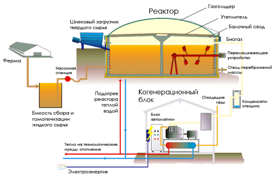
Рис.1. Устройство биогазовой установки
