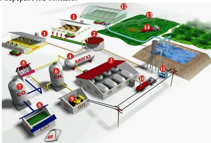
Рис. 5. Техническая схема биогазовой установки : 1- животноводческие корпуса с самосплавной системой навоза удаления; 2- приёмная ёмкость экскрементов, подготовка сырья к загрузке в реакторы для переработки; 3 - биогазовая установка; 4 - газгольдер для сбора биогаза; 5 - глекислотная разделительная колонка; 6 - газгольдер с метаном; 7 - газгольдер с углекислым газом; 8 - культивирование хлореллы и получение биологического витаминного концентрата; 9 - газогенератор; 10 - вывоз полученных минерализованных азотных удобрений на поля; 11 - электронасос; 12 - теплица выращивания гидропоники; 13 - самоходная круговая система орошения; 14 - внесение минерализованных азотных удобрений
