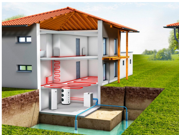
Рис. 5. Коттеджный загородный дом с применением геотермальной установки
